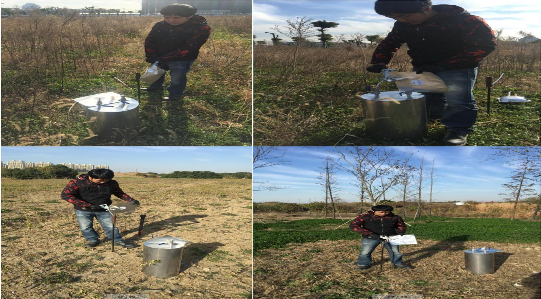
附图 10: 土壤气（静态暗箱富集法）采样工作照片
