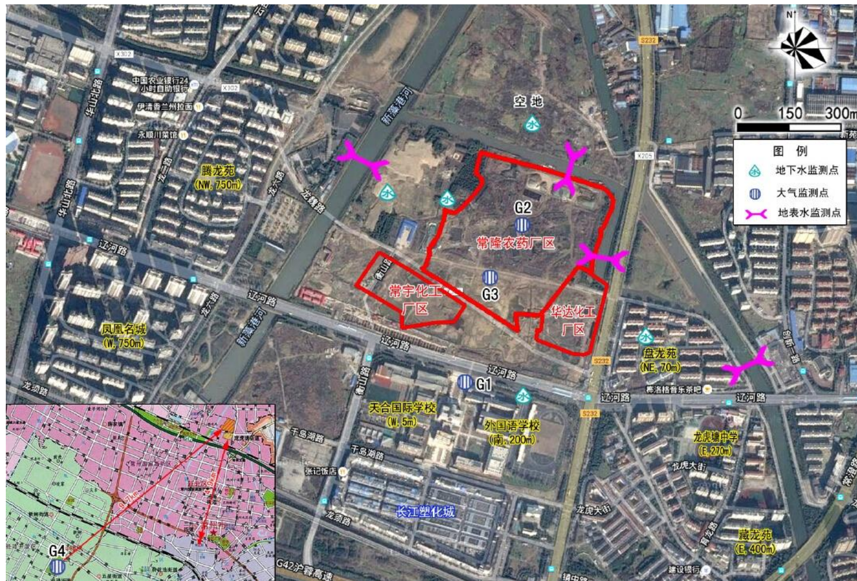
附图 4 环境监控方案环境空气、地表水、地下水监测点位示意图
