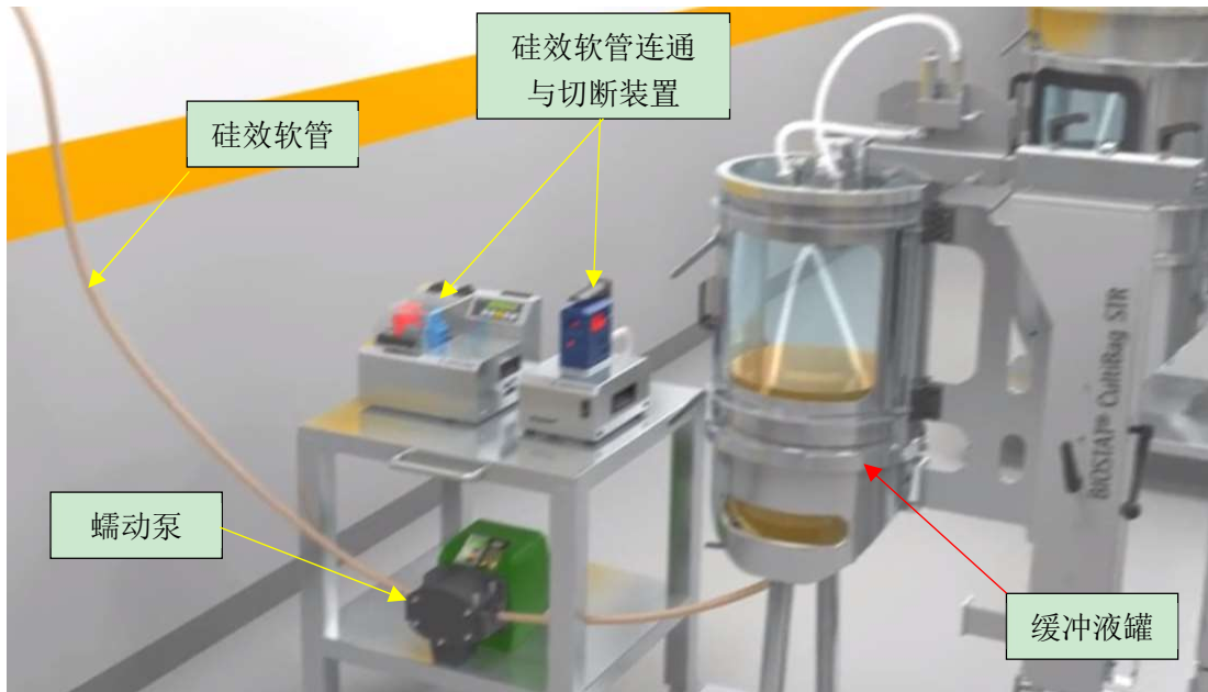
图 6.2-3 液体原料输送加料示意图
