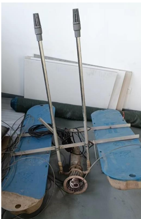
图2-21 双桥浜氨氮降解曝气装置示意图
