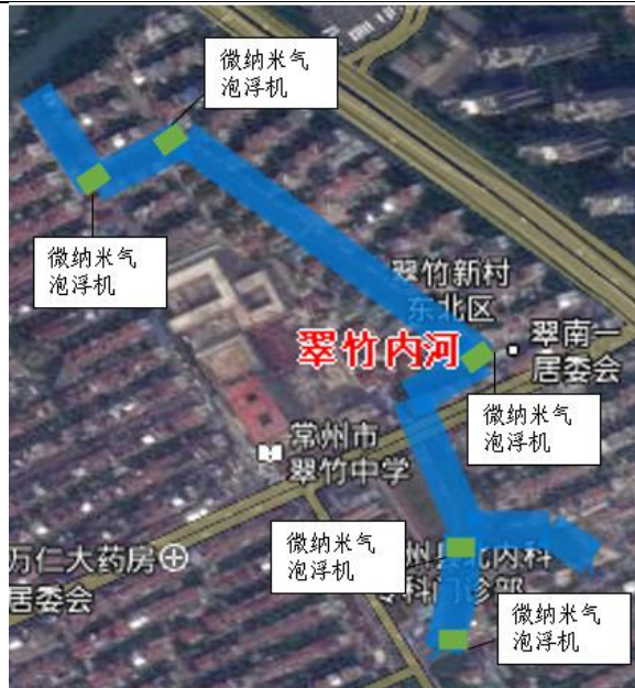
图2-16 翠竹内河微纳米气泡浮机位置示意图
